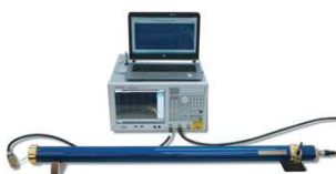
케①블 차폐 성능 측정 시스템
